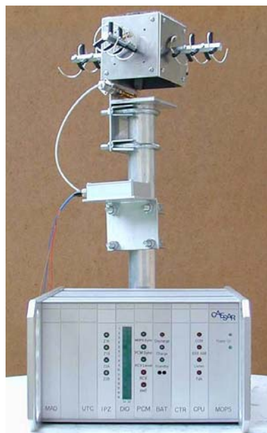
Bild 12: Telemetrie-Empfangsanlage mit vier zirkular polarisierten Rundumstrahlantennen und direkter, digitaler Einspeisung in das PCM-Interface eines Erfassungssystem
